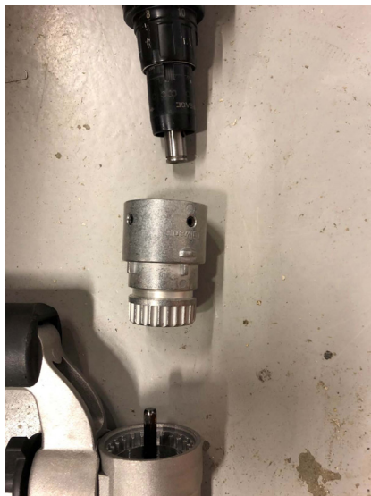
Adapteret settes på spissen og skyves helt på plass og pinolskruer strammes til.
