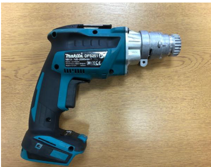
Monter QD adapteret så det sitter helt tilbake mot maskinen.
