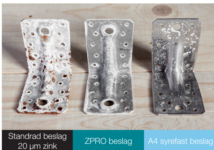
Bilde: Test i salttåkekammer 1400 timer, tilsvarende ca. 15 år i normalt utendørs miljø
